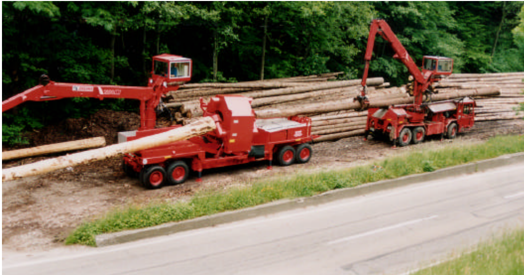
Abbildung 2: Entrindungsmaschine im Einsatz (Foto: Weiß)
