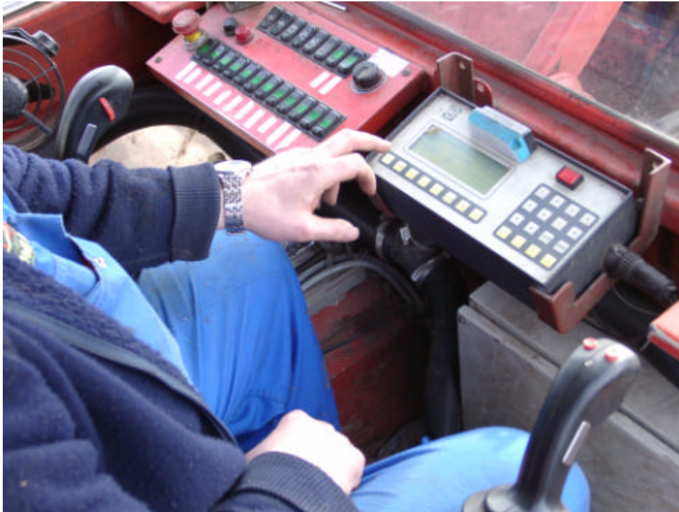
Abbildung 12: Funkterminal in Krankkabine (Foto: Weiß)
